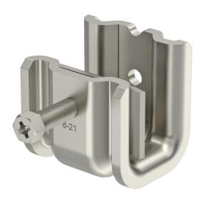
Diese Art Trägerklammer wird auf den Träger aufgeschoben und mittels einer Druckwanne und Schraube (M8) am Träger oder Flacheisen fixiert. Die Sechskantschraube hat eine Schlüsselweite von 10 mm. Im Schellenkörper sind außerdem zwei weitere M8 Gewinde eingebracht, um zum Beispiel Gewindestangen zu befestigen.
